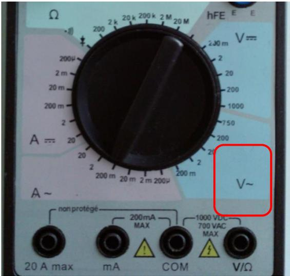
Le voltmètre peut mesurer une tension alternative périodique en utilisant le **cadran V ~**, en se plaçant entre les bornes V et COM, en dérivation sur l'appareil étudié.
